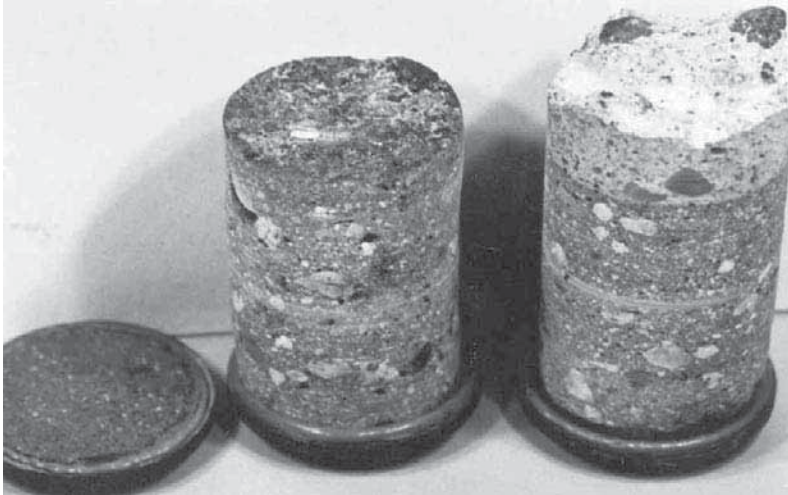
รูปที่ 31 แท่งคอนกรีตที่ผ่านการทดสอบการยึดเกาะของคอนกรีต (ที่มา: ACI 555) (ข้อ 6.7.1)
