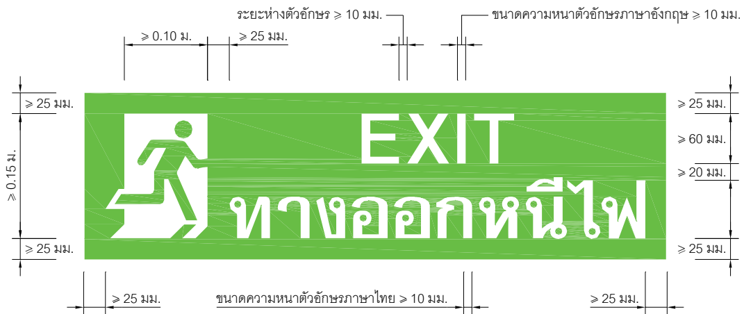
(ก) ขนาด ระยะ และรูปแบบป้าย หรือเครื่องหมายแสดงทางออกหนีไฟ
